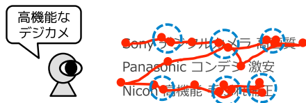
図 6 視線の動きの 2 つのパターン. 図中の塗りつぶしの小円は一定時間ごとの視線位置を表している. 視線位置が短時間で一定範囲に集中しているパターンは停留と呼ばれ, 破線の大円部に相当する. 一方, 対象物の変更時に生じる停留点の急速な移動は, サッカードと呼ばれる
