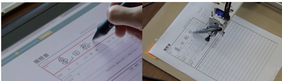
図 7.2: ひととロボットの協調による手書き文字美化システム (左がユーザの手書き文字、右がロボットによって美化して出力された文字)
